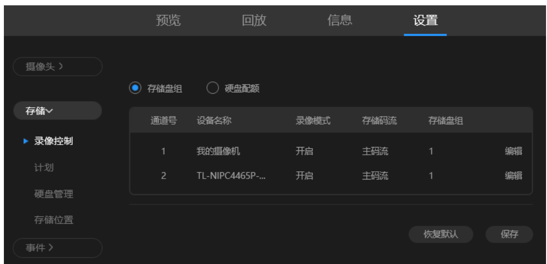
图 5-8 设置 - 存储 - 录像控制界面
