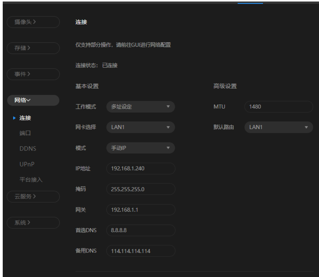
图 5-21 设置 - 网络 - 连接 - 多址设定
