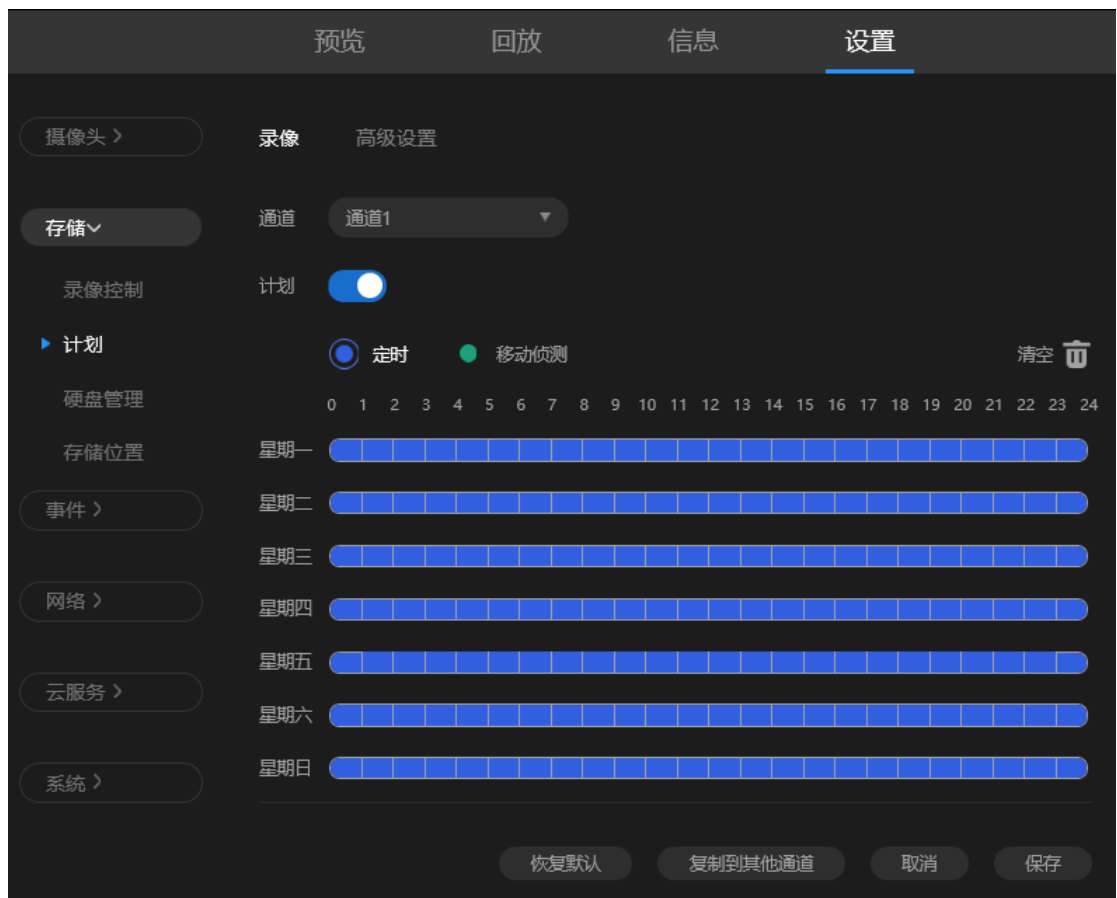
图 5-12 设置 - 存储 - 计划 - 录像界面
